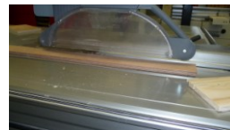
plaatmateriaal: zaag 10 mm boven plaat
