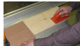
plaatmateriaal: zaag 10 mm boven plaat
